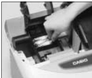
3. Achten Sie auf die (+) und (-) Markierungen im Batteriefach. Setzen Sie drei neue SUM-3 (UM-3) Batterien so ein, dass ihre positiven (+) und negativen (-) Enden in die markierten Richtungen weisen.
